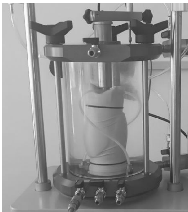
Рис. 1. Характер разрушения песчаного образца.
