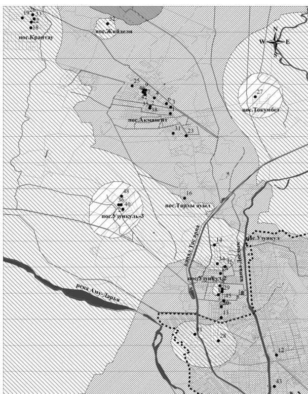
Рис. 2. Карта-схема осадок ленточного фундамента (см). Давление под фундаментом 50 кПа.
