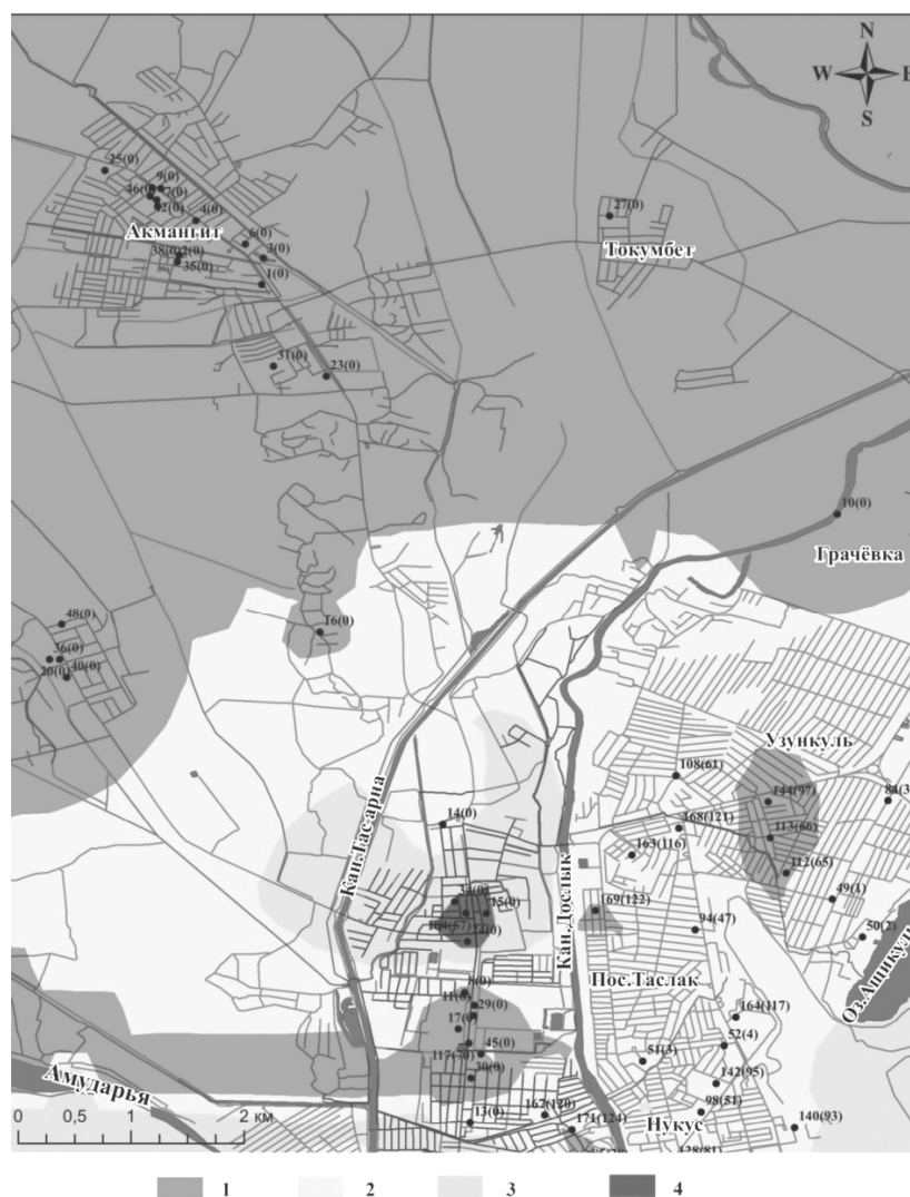
Рис. 3. Карта-схема засоления грунтов Нукусского района (до уровня подземных вод) по типам засоления (соотношение ионов Cl/SO_4 ): 1 - 0,04-0,2 (сульфатный); 2 - 0,2-1 (хлоридно-сульфатный); 3 - 1-2 (сульфатно-хлоридный); 4 - 2-4,781 (хлоридный); ● – скважины.
