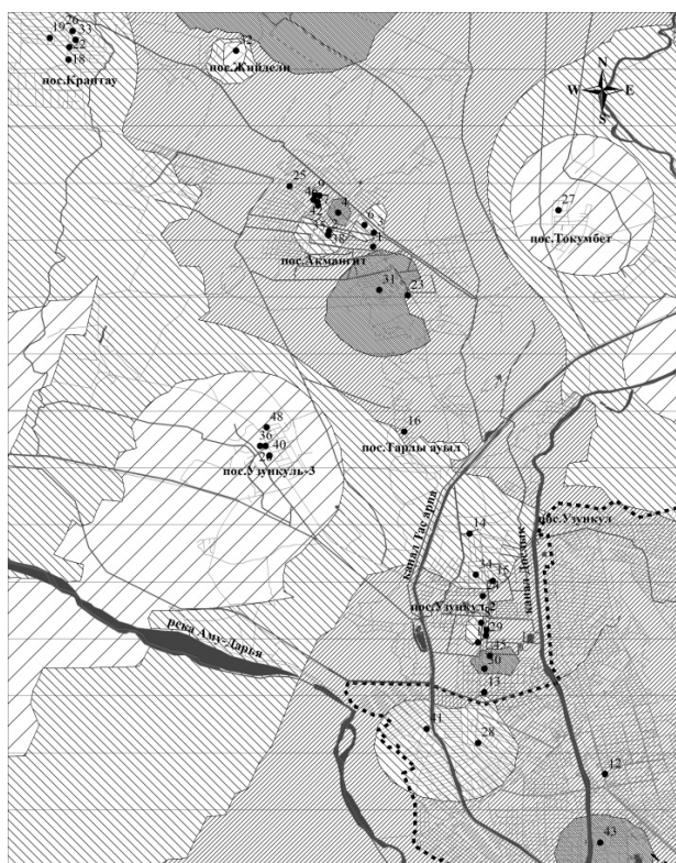
Рис. 6. Карта-схема осадок ленточного фундамента (см). Давление под фундаментом 250 кПа.
